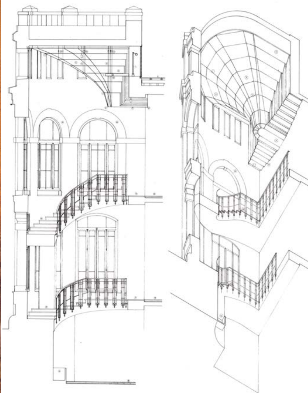
28. Escalera absidal. Sección. / Axonométrica.
